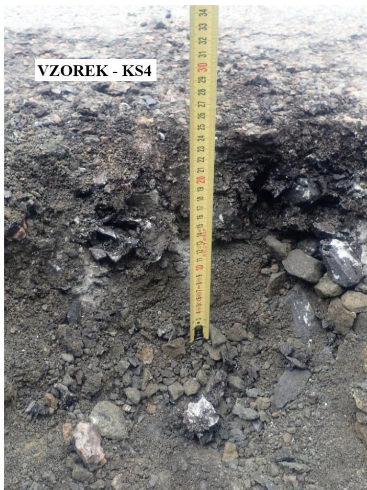
Obr. 4 – Kopaná sonda Vzorek – KS4 (in situ).
